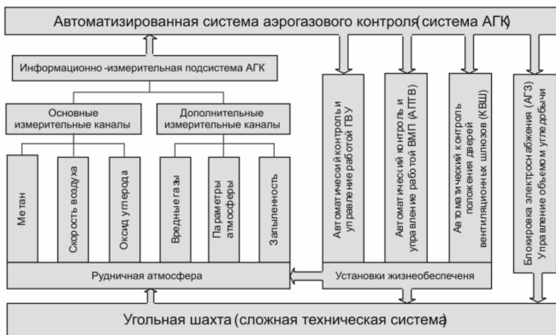
Функциональная схема системы аэрогазового контроля в угольной шахте
